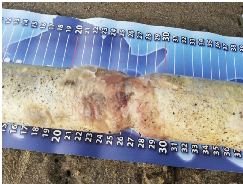
Figuur 2: Detailfoto van de beschadiging bij een knakaal.
