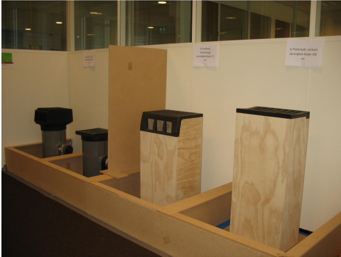
Foto 4: v.l.n.r. hoekkolk met ronde opvangbak, straatkolk met ronde opvangbak, hoekkolk met rechthoekige opvangbak en straatkolk met rechte opvangbak.
