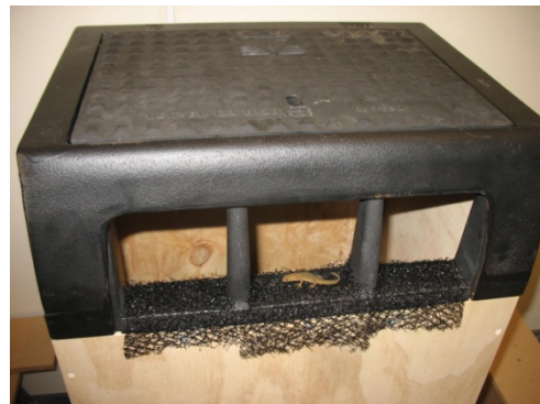
Foto 11: vooraanzicht hoekkolk met begroeiingsmat. In de middelste opening een kleine watersalamander die via de begroeiingsmat de weg naar boven gevonden heeft.
