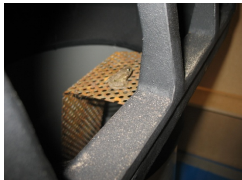
Foto 6: het bovendeel van de aluminium loopstrip in straatkolke tijdens de proefopstelling
