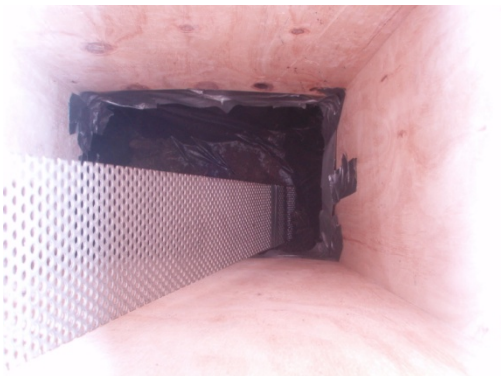
Foto 5: bovenaanzicht van de aluminium loopstrip in hoekkolke tijdens de proefopstelling
